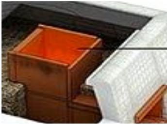
**3. Cámara de combustión:** La cámara de combustión es el elemento principal de toda estufa ahorradora de leña, Ésta es la estructura de mayor importancia para aumentar la eficacia en el consumo de leña, es en donde se introduce la leña y que luego transmite el calor a la plancha.
