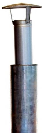
**6. Chimenea de 3 tubos de lámina:** calibre 26 de 4" de diámetro, con sombrero, unida mediante un codo del mismo material, ensamblado a una pieza de metal de 25 \* 12 \* 4 cm, para evitar que la arena obstruya el codo y permitir la evacuación del humo. Además, se coloca malla de protección sobre los tubos para evitar quemaduras y un anillo de hierro con pata, para sostener el tubo en la parte de arriba.
